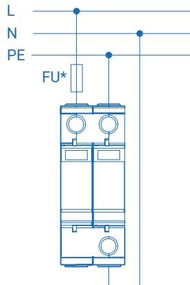
УЗИП в монолитном корпусе
