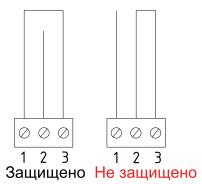
Схема подключения ДС
