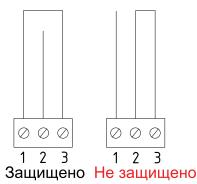
Схема подключения ДС
