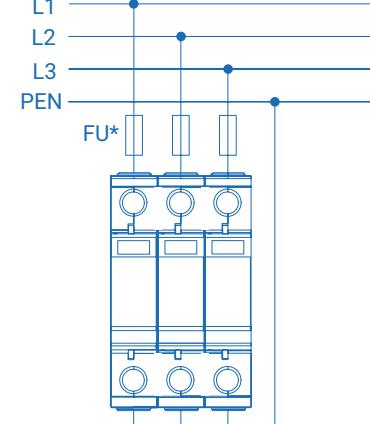
УЗИП в монолитном корпусе
