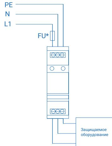
УЗИП в монолитном корпусе
