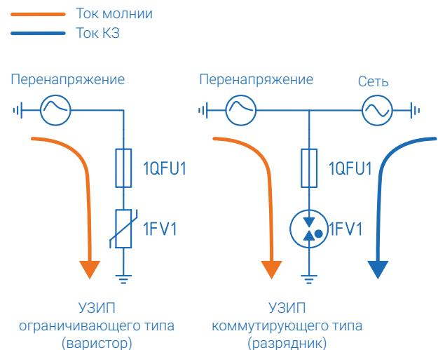
**Рис. 11.** – Источники тока при срабатывании УЗИП ограничивающего и коммутирующего типа
