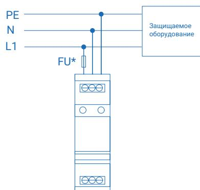
УЗИП в монолитном корпусе
