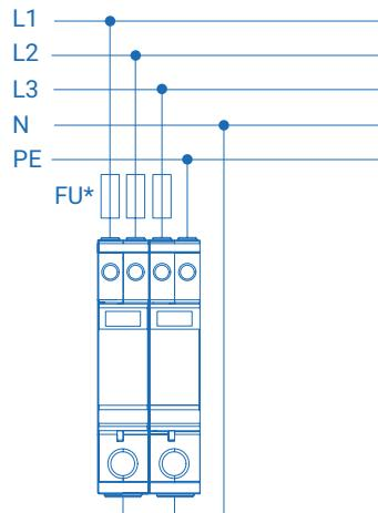
УЗИП в монолитном корпусе
