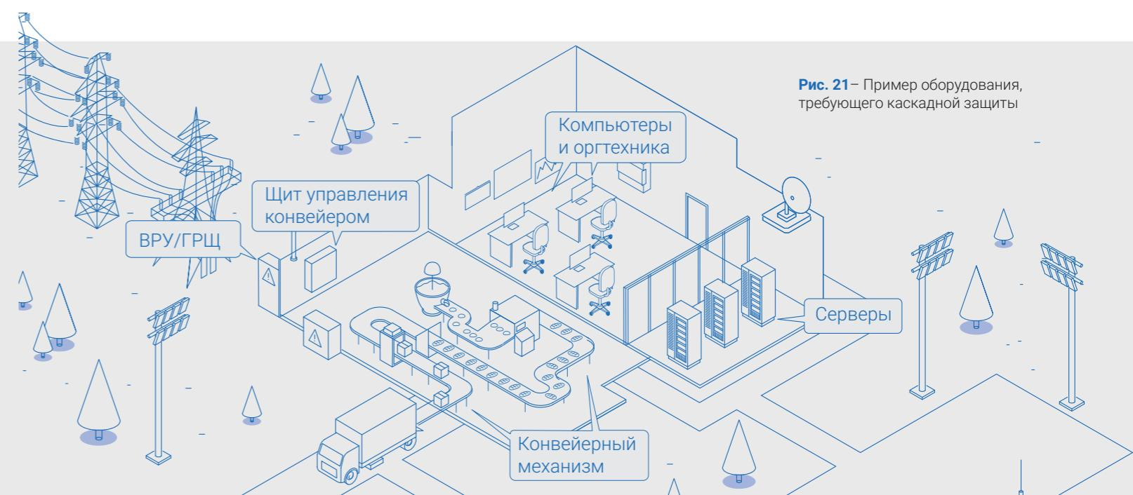
Рис. 21 – Пример оборудования, требующего каскадной защиты
