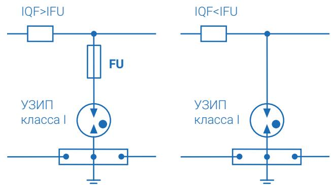
**Рис. 12.** – Подключение УЗИП класса I
