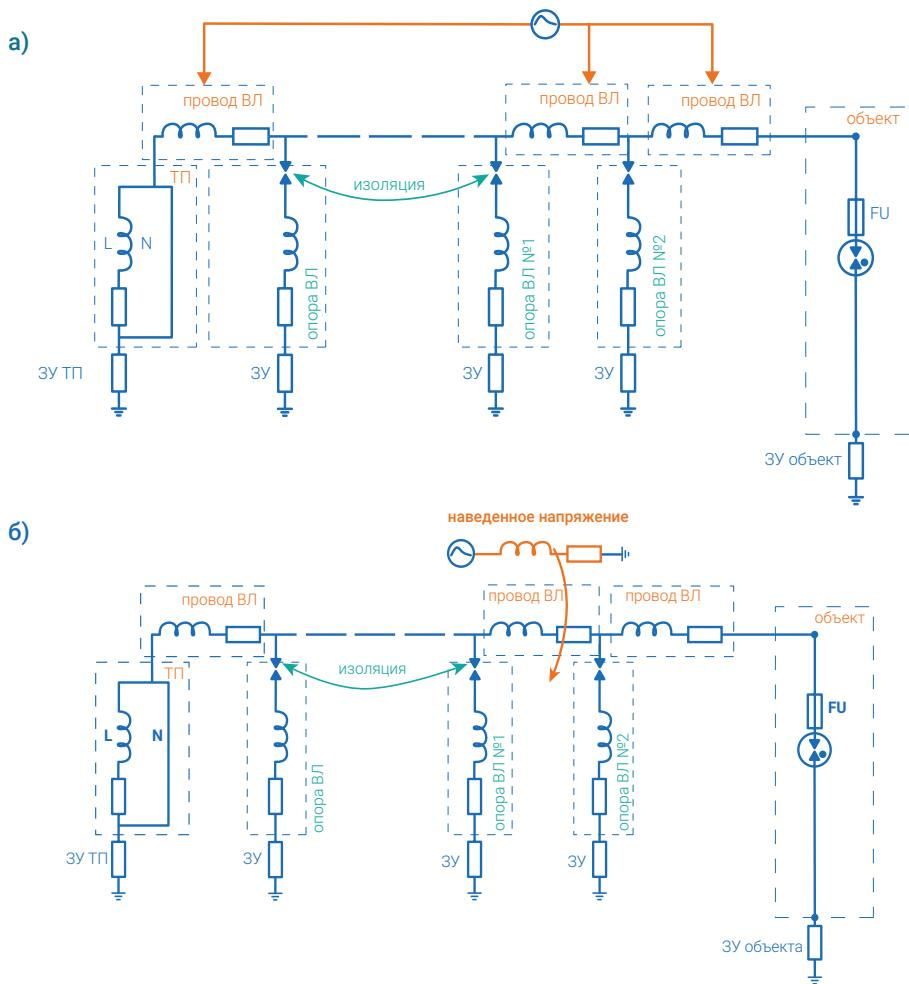
**Рис. 14** – Схемы замещения для оценки токов через УЗИП при отсутствии у объекта системы молниезащиты и наличии отходящей ВЛ 0,4 кВ
