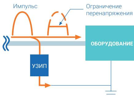
В каких случаях применяется УЗИП? Такие ситуации возникают всегда, когда сеть связывает источник перенапряжений и приемник (устройство, которое воспринимает помехи). Необходимо применять УЗИП для защиты размещенного на конструкциях с молниевыводами прожекторного оборудования, систем вентиляции и видеонаблюдения на кровлях зданий.
