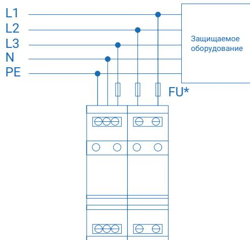
УЗИП в монолитном корпусе
