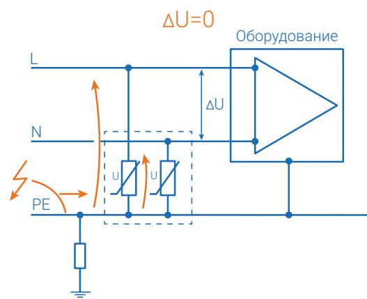
**Рис. 16** – Эффективность работы УЗИП в схемах подключения для защиты от противофазных «1+1» и синфазных «2+0» перенапряжений (упрощенно оценен уровень остаточного напряжения  $U_p$ , приложенного к изоляции оборудования L/N)
