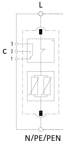
Мощное однополюсное УЗИП класса I ограничивающего типа. УЗИП выполнено в виде сменного варисторного модуля и базы для подключения к сети и креплению на DIN-рейку.
