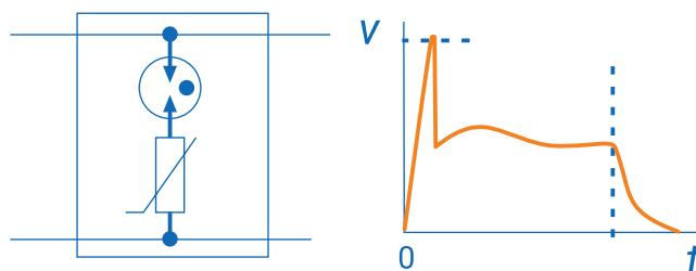
**Рис. 4.** Форма импульса напряжения при срабатывании УЗИП комбинированного типа
