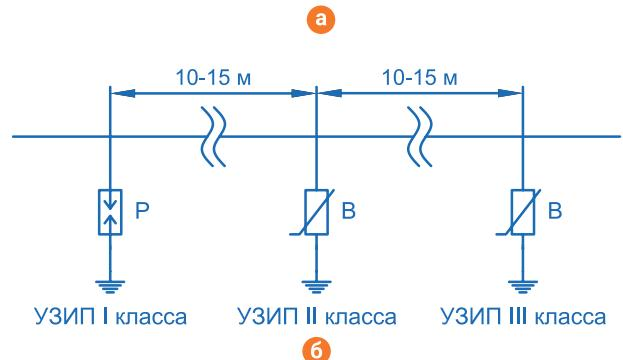
**Рис. 10.** Обеспечение селективной работы УЗИП:
