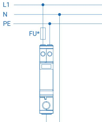
УЗИП в монолитном корпусе
