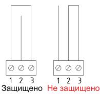
Схема подключения ДС
