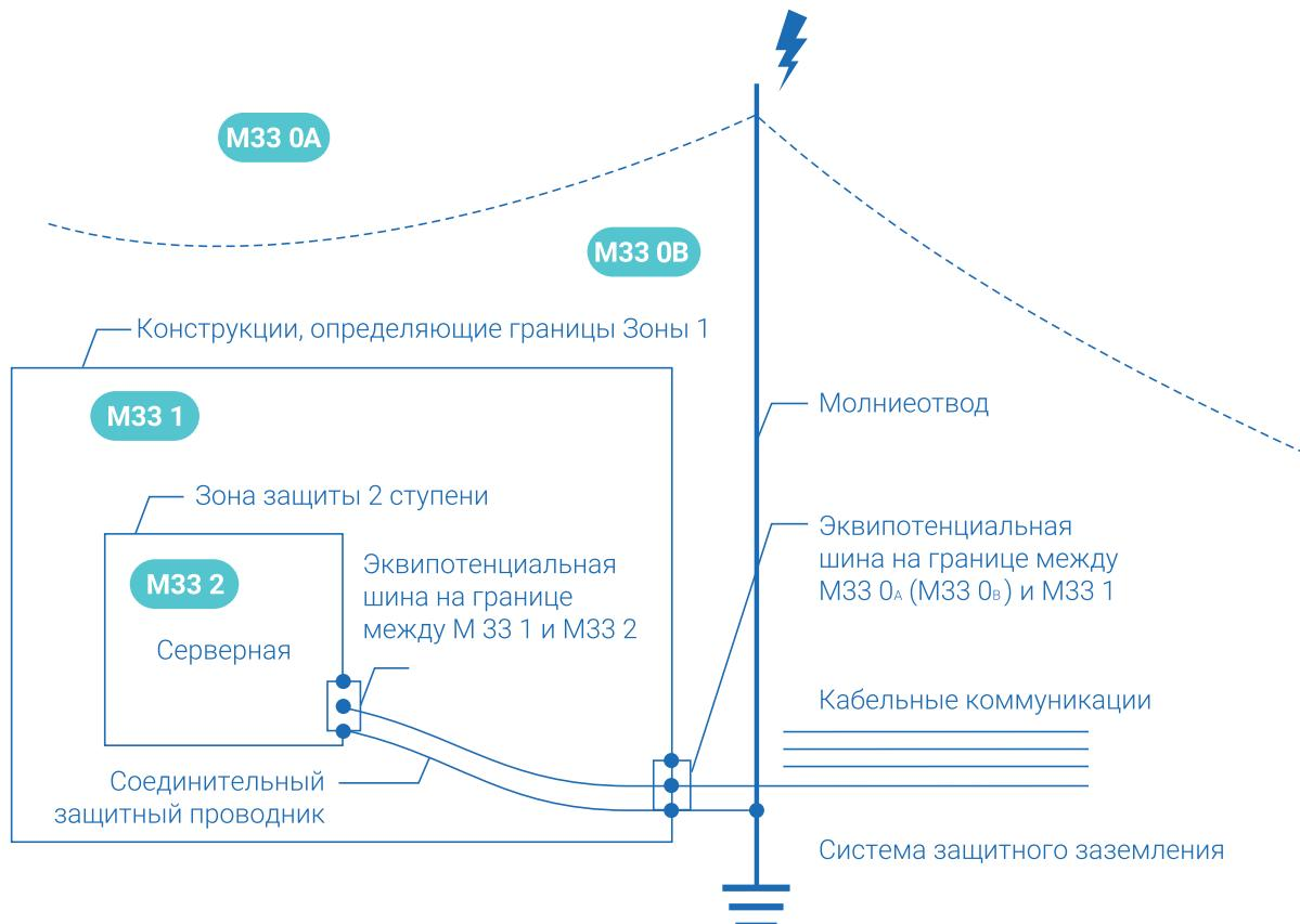
**Рис 1.** Применение зонной концепции молниезащиты объекта
