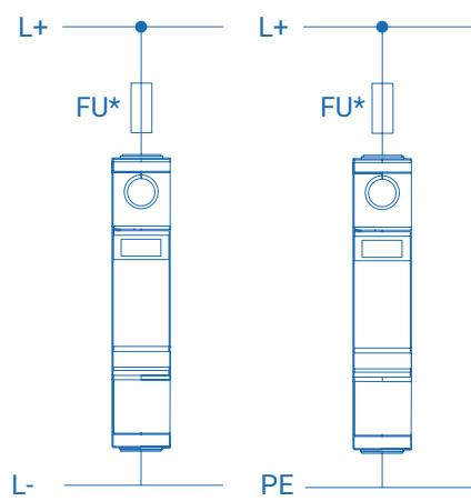
УЗИП в монолитном корпусе
