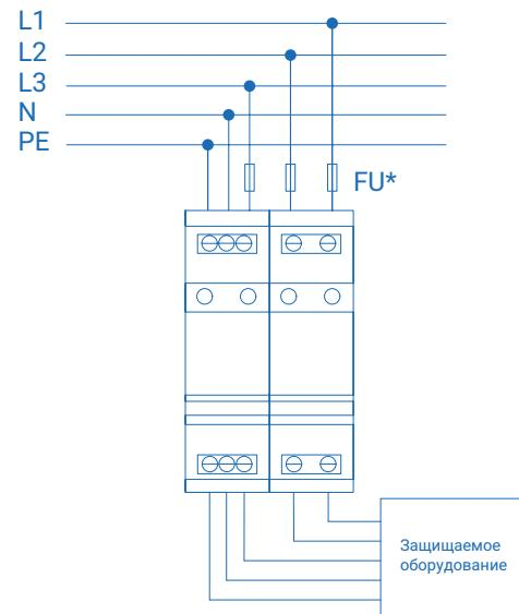
УЗИП в монолитном корпусе
